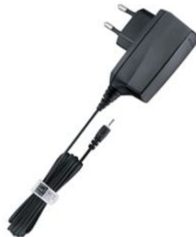
Fig. 22 Cargador de teléfono móvil, que será utilizado como fuente de alimentación para los circuitos lógicos.
