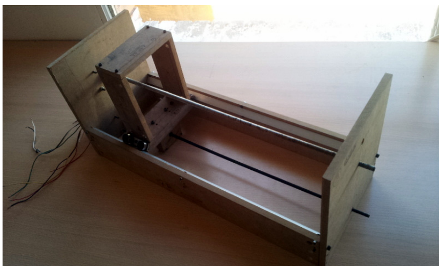
Fig. 82 Estructura de la bobinadora terminada
