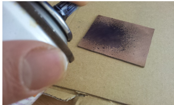
Fig. 38 Aplicación del spray fotosensible
