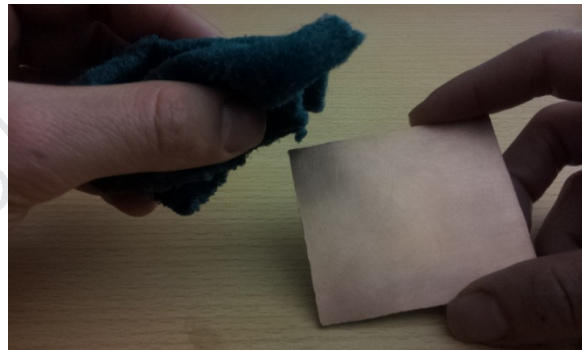
Fig. 36 Limpieza de la placa de cobre con estropajo.
