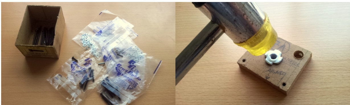
Fig. 68 A la izquierda, tuercas y tornillos varios, en la parte derecha se observa la tuerca de uña siendo clavada.
